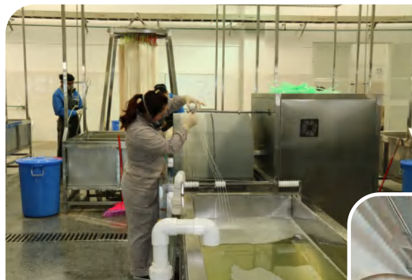
膜厂纺丝车间工人正在进行 pvdf 材料纤维膜丝工艺操作
